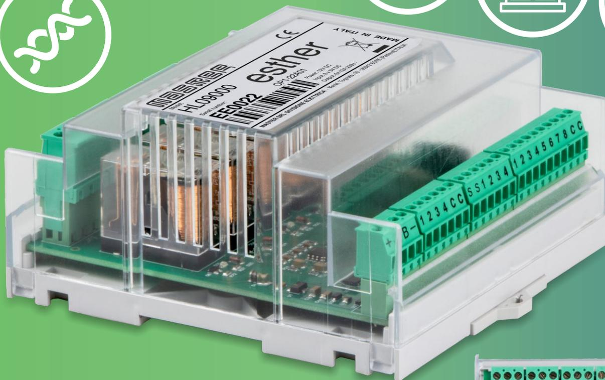
**Esther** è la nuova scheda multifunzione di potenza del sistema UNA che sostituisce la scheda MiniEva incrementando funzionalità e capacità.
