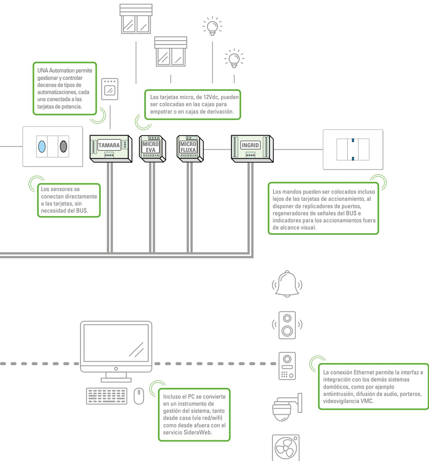
Diagrama de ejemplo: para las instrucciones detalladas del cableado, consultar los manuales UNA Automation.
